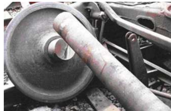
Рис. 1. Разрушение колёсной пары
